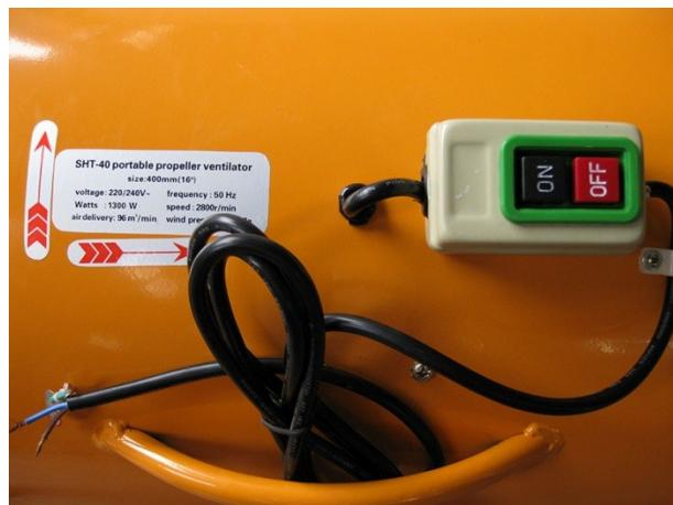
Вентилятор серии SHT предназначен для продувки колодцев (теплофикационных, канализационных, кабельных, водопроводных и др.), закрытых помещений перед проведением в них ремонтных и профилактических работ, тепловизионного контроля, осмотров, измерений и т.п., а также для организации приточной и вытяжной вентиляции с целью соблюдения требований безопасного выполнения вышеперечисленных работ. Вентилятор SHT может работать как в режиме приточной вентиляции, так и в режиме вытяжки.
